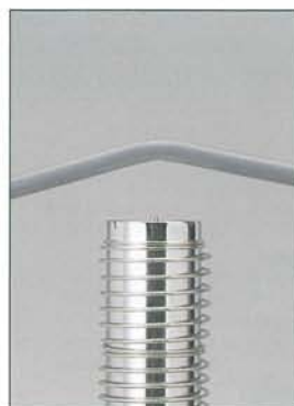
塩ビパイプの曲げ加工
